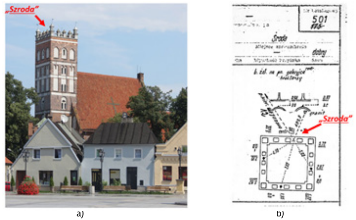
Rys. 8 Lokalizacja punktu „Szroda” (kościół Wniebowzięcia NMP w Środzie Wielkopolskiej; a) położenie punktu na galerii wieży kościelnej (na podstawie fot. Wikipedia); b) fragment opisu topograficznego z lokalizacją punktu (na podstawie materiałów z POD-GiK pow. średzki)
